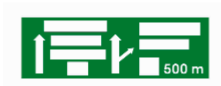
(Π-83) Γέφυρα σήμανσης με αναγραφή κατευθύνσεων προ ανισόπεδου κόμβου
